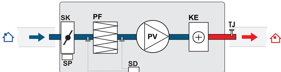
PV - вентилятор приточного воздуха
