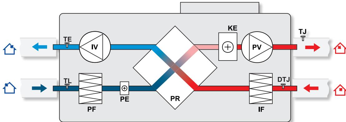
\* - Летняя кассета может быть применена к RIS-400 PE 3.0; RIS 700 PE 3.0. Используется для закрытия пластинчатого теплообменника в течение теплого периода года, когда утилизация тепла не приносит никакой пользы.
