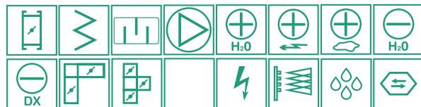
Установка кондиционирования воздуха с рекуперацией тепла. Используется пластинчатый противоточный теплообменник. Агрегат может состоять из вентилятора, нагревателя (водяного или электрического), охладителя (водяного или фреонового), фильтров, рециркуляционной секции, секции глушителя, может прилагаться заслонка.
