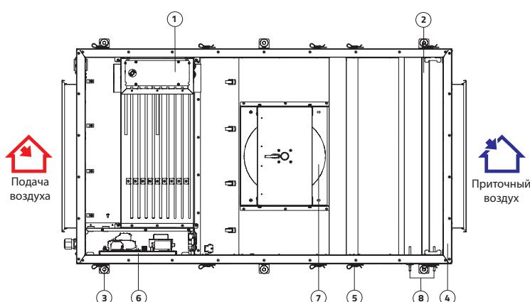
1. Электрический нагреватель (дополнительно заказывает и подключает пользователь)/или водяной нагреватель VEGA 1100W
