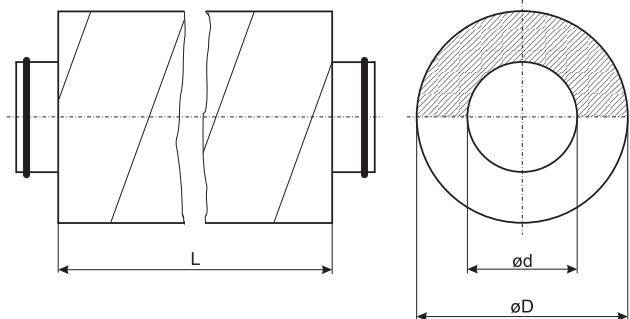
Круглый глушитель. Хорошо подавляет шум, легко устанавливается в систему воздуховодов. При высоком уровне шума в системе круглых воздуховодов устанавливаются несколько глушителей. Корпус изготовлен из оцинкованной жестяной ленты, которая спирально сворачивается в трубу SPIRO и заполнена звукоизолирующей минеральной ватой. Внутренняя стенка изготовлена из перфорированной листовой оцинкованной жести и заполнена звукоизолирующей минеральной ватой.
