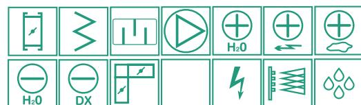
Установка кондиционирования воздуха для подачи свежего воздуха в помещение. Агрегат может состоять из вентилятора, нагревателя (водяного или электрического), охладителя (водяного или фреонового), фильтров, рециркуляционной секции, секции глушителя, может прилагаться заслонка.
