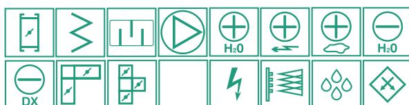
Установка кондиционирования воздуха с рекуперацией тепла. Используется пластинчатый теплообменник. Агрегат может состоять из вентилятора, нагревателя (водяного или электрического), охладителя (водяного или фреонового), фильтров, рециркуляционной секции, секции глушителя, может прилагаться заслонка.
