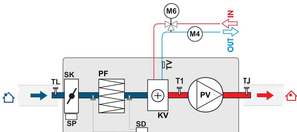
PV - вентилятор приточного воздуха
