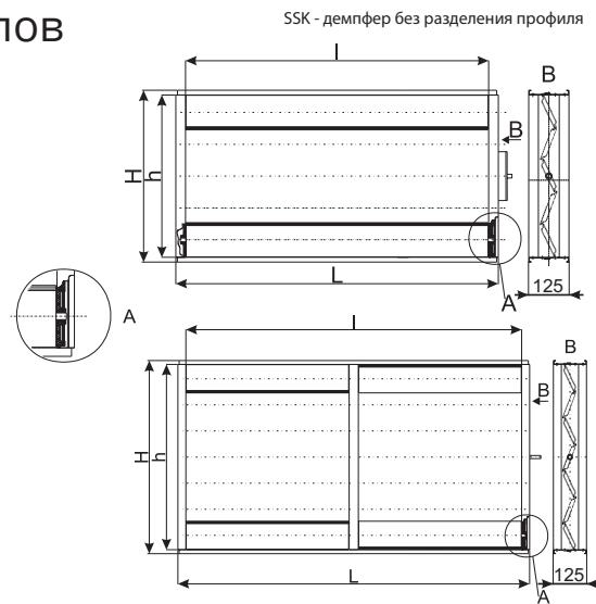
Заслонки для SSK для регулировки воздушного потока. Заслонки изготовлены из алюминиевых профилей с резиновым уплотнителем. Управляющий механизм лопаток изготовлен из стекловолокна а . Уплотнительный материал обеспечивает необходимую герметичность заслонок. Заслонки пригодны к эксплуатации в температурном диапазоне от -40°C до +80°C. Так как фланцевая система этих заслонок такая же, как в прямоугольных воздуховодах или вентиляторов, она легко монтируется.
