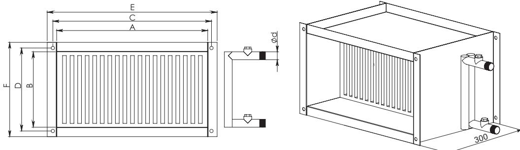
Используется в системах вентиляции. SVS воздухонагреватели изготовлены из медных трубок и алюминиевых пластин. Корпус изготовлен из оцинкованной стали. Нагреватели и охладители можно подобрать в соответствии с имеющимися параметрами, используя программу подбора, которую можно найти на интернет-сайте [www.salda.lt](http://www.salda.lt)
