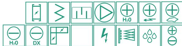
Установка кондиционирования воздуха с рекуперацией тепла. Используется роторный теплообменник. Агрегат может состоять из вентилятора, нагревателя (водяного или электрического), охладителя (водяного или фреонового), фильтров, рециркуляционной секции, секции глушителя, может прилагаться заслонка.
