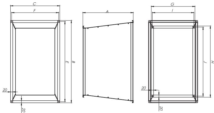
Фланцевые адаптеры используются для соединения со стандартными АНУ вентиляционных каналов. Адаптеры выполнены из оцинкованной стали.
