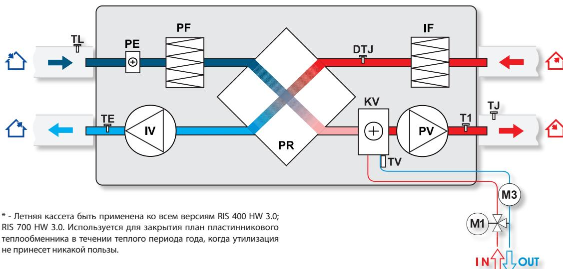
\* - Летняя кассета быть применена ко всем версиям RIS 400 HW 3.0; RIS 700 HW 3.0. Используется для закрытия план пластинникового теплообменника в течении теплого периода года, когда утилизация не принесет никакой пользы.
