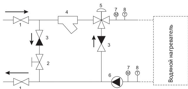
Основной функцией точки смешивания является контроль, совместно с системой управления, температура подаваемой воды в водонагревателях. Используется для контроля воды температуры в обогревателях, воздушных завес и т.д. точкой смешения используется наряду с другими устройствами (закрывающей заслонками, датчик температуры, системы управления) с целью защиты нагревателей от замерзания.
