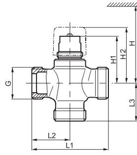
Используется в системах вентиляции для регулирования температуры подаваемой воды в водонагревателях. Для фанкойлов, небольших повторных нагревателей и небольших повторных охладителей.
