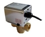
Зональные клапаны ZV-S рекомендуются к использованию для всех систем кондиционирования и отопления с функцией безопасности на случай прерывания электроснабжения. В таких случая, пружина обеспечивает безопасное закрытие.
