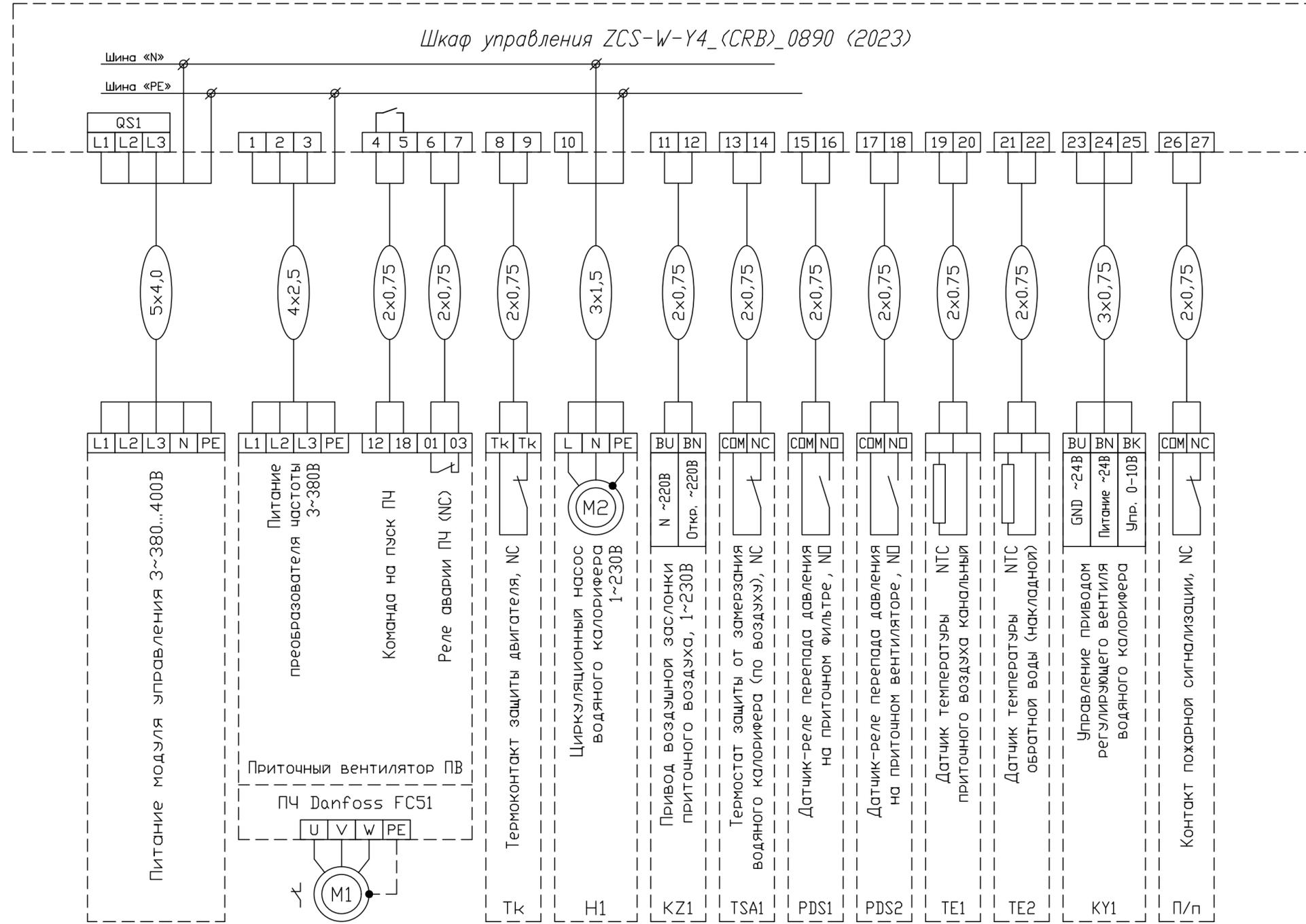
1. Нумерация клемм преобразователей частоты дана для ПЧ "Danfoss" FC 51.
