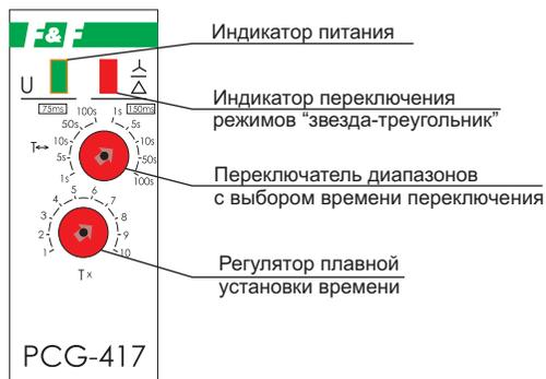
Реле времени программируемое PCG-417 выполнено в одномодульном корпусе для крепления на DIN-рейку 35мм. На панели управления находятся индикаторы питания, переключения режимов “звезда-треугольник”, регулятор плавной установки времени, переключатель диапазонов с выбором времени переключения.
