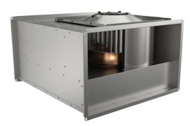
**Двигатель:** Вентиляторы данной серии оборудованы электродвигателями с внешним ротором и рабочим колесом с загнутыми вперед лопатками. Для защиты электродвигателя от перегрева вентиляторы оснащены встроенными термисторами (РТС - положительный температурный коэффициент) с выводами для подключения к внешнему устройству защиты U-EK230E.
