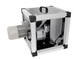
**Двигатель:** Используются электродвигатели, соответствующие стандарту IEC, класс энергоэффективности IE2 для двигателей от 750Вт/400В. Рабочее колесо имеет загнутые назад лопатки, выполненные из алюминия. Вентилятор MUB/T применим для постоянной работы при температуре воздуха до 120°C. Электродвигатель вынесен из потока перемещаемого воздуха, защищен решеткой и оснащен встроенными термисторами с выводами для подключения к внешнему устройству защиты.
